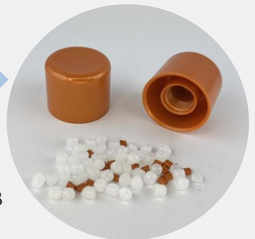
Allgemein ist zu beachten, dass bei einem Artikel aus PCR von Materialcharge zu Materialcharge z.B. unvermeidbare Farbtonunterschiede oder Schmutzeinschlüsse auftreten können. Die Erstellung eines Range-Boards ist nicht möglich, da seitens des PCR-Herstellers keine Garantie bezüglich möglicher Schwankungen gegeben werden kann.
